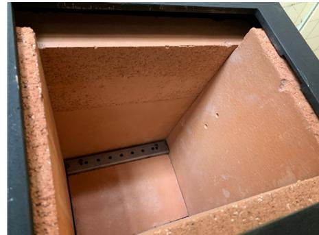
Legen Sie dann die Bodenplatte S5 ein und den Rückwandstein S6. Setzen Sie die Airbox wieder ein.
