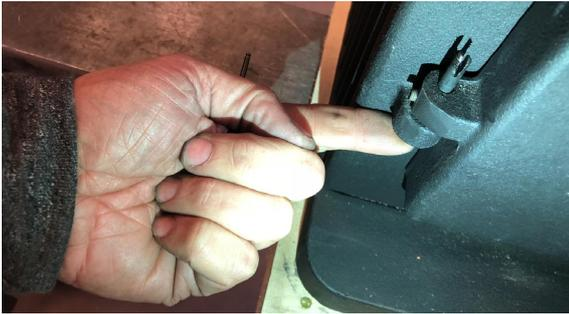
Platzieren Sie die Feder auf dem Splint. Setzen Sie die Schraube auf und justieren Sie die Spannkraft der Feder
